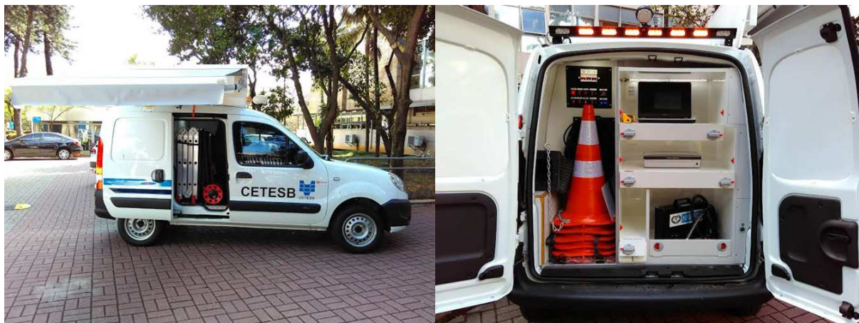
Figura 9 - Unidade móvel de fiscalização equipada com opacímetro
