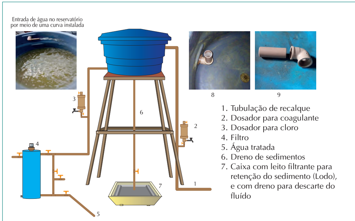
Figura 1 – Solução Alternativa de Tratamento de Água (SALTA-z).
