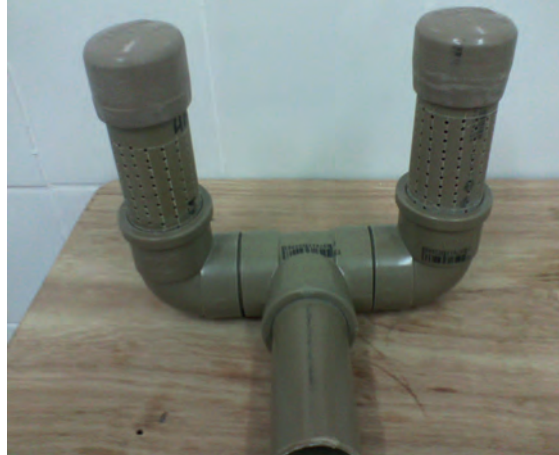
Fixação das tampas (parafusos e cola estruturante)
