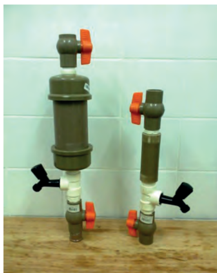
Figura 9 – Ilustração do dosador para coagulantes em diferentes tamanhos.
