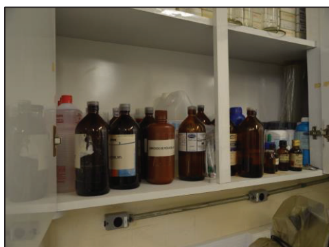
Figura 8 - Exemplo de armazenamento inadequado de produtos químicos
