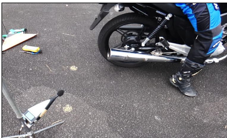
Figura 1 – Ensaio de ruído parado
