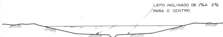
SEÇÃO COM BERMAS INCLINADAS COM CANALETA
