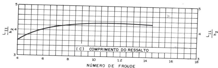
FIGURA 2-6. CARACTERÍSTICAS DA BACIA DE DISSIPAÇÃO PARA F_R > 4,5
