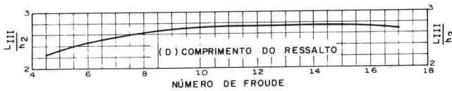
FIGURA 2-5. CARACTERÍSTICAS DA BACIA DE DISSIPACÃO PARA F_R > 4,5 E V_1 < 18 \text{ m/s}
