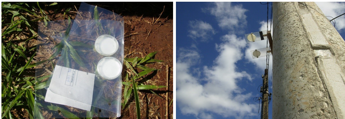
Foto 3.2.1 – Sistema de coleta de amostras de fluoretos na atmosfera
