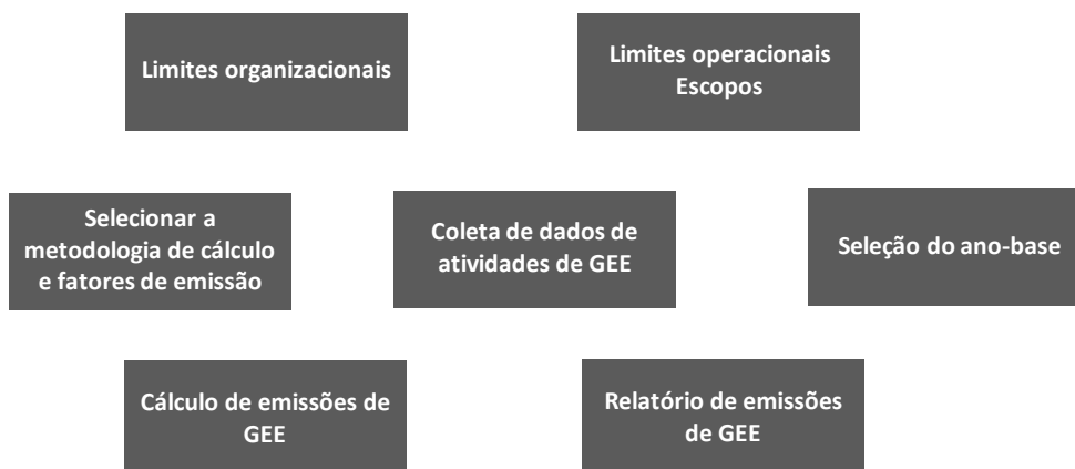
Figura 3 - Etapas para a elaboração do inventário de emissões de gases de efeito estufa
