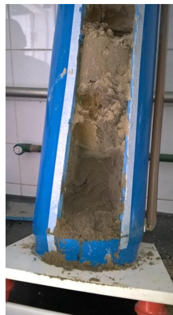
Figura 3.6 – Coleta de solo com amostrador EnCore e pontos de coleta de sedimento (superior e inferior).
