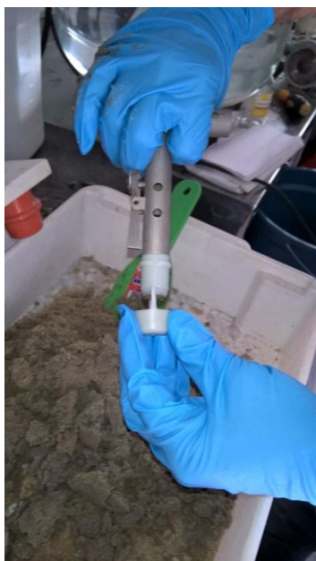
Figura 3.6 – Coleta de solo com amostrador EnCore e pontos de coleta de sedimento (superior e inferior).
