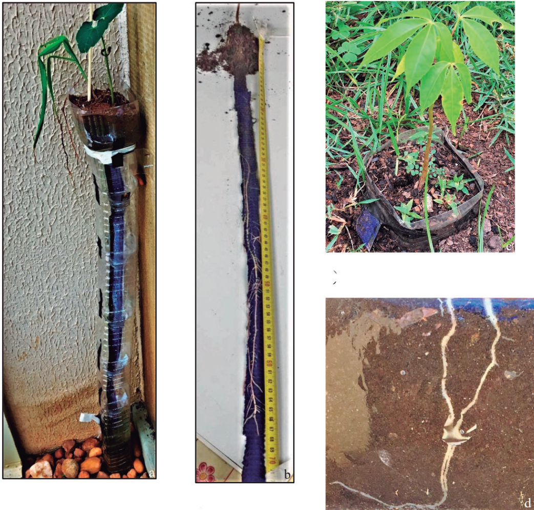
Figura 3. Detalhe dos dois tipos de irrigadores. Em a) um irrigador tipo ZE, montado dentro de uma coluna transparente, para permitir a observação do fluxo ascendente de água desde o solo até as raízes do milho e do feijão, plantados um metro acima. Em b) um irrigador DA sem a cobertura de proteção, permitindo que se observe o torrão da muda e raízes enraizadas numa fita de microfibra, já com 68cm de comprimento. Em c) detalhe num teste simples feito com uma muda de uma espécie florestal envasada e colocada no solo, mas que não recebia água dele. Nesse caso, um irrigador ZE colocado lateralmente (visível na foto) transferia água de camadas profundas até o solo e a planta. Em d) detalhe de raízes que cresceram para fora de um irrigador DA, que havia sido colocado no solo há apenas 12 dias. Pode-se ver, na parte superior da foto, a ponta da fita da microfibra usada para captar água do solo por onde as raízes longas saíram, promovendo aí um enraizamento profundo. Nesse caso, em poucos dias, a planta começa a captar água e nutrientes em camadas mais profundas do solo do que aquela alcançada pelo irrigador no momento do plantio. Isso permite que, inicialmente, a planta beneficie-se da água que sobe por capilaridade pela fita, mas também que, com o tempo, ela passe a captar abaixo da ponta da fita, permitindo que a irrigação persista mesmo que o solo seque onde está a ponta do irrigador.
