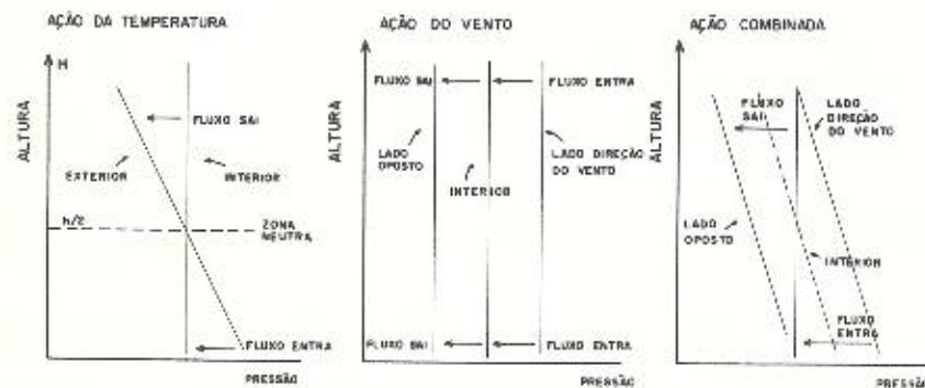
FIGURA 5.1 Distribuição de pressões internas e externas sobre a altura de um edifício
