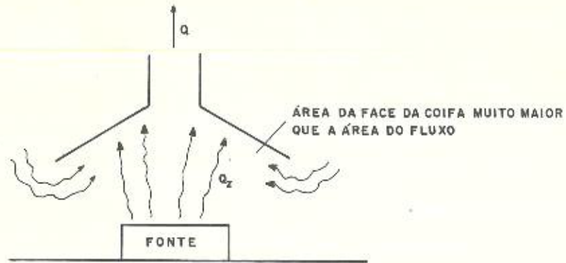
FIGURA 6.27 Esquema da ventilação de pequenas fontes quentes usando grandes coifas
