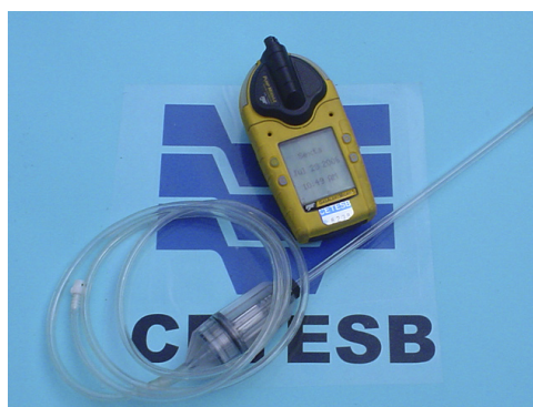
Figuras 14 e 15 – Equipamentos para detecção de gases e vapores tóxicos e inflamáveis
