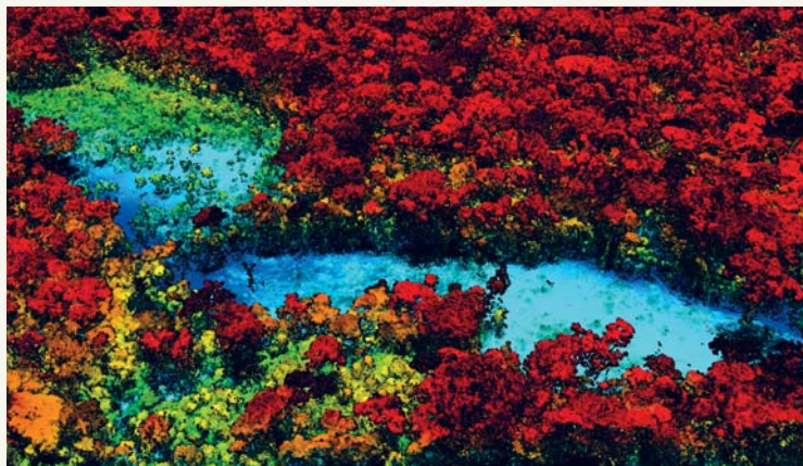
Figura 29: Medições por laser – LIDAR – avaliam a biomassa florestal, criando perfis 3-D da floresta até a escala de árvores específicas (Tollefson, J., 2009)
