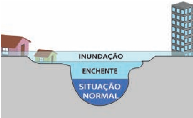
Perfil esquemático de inundação e enchente (Modificado de Ministério das Cidades/IPT, 2007).
