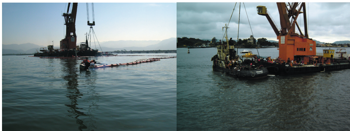
Figuras 4.18 e 4.19: Rebocador afundado e operação de contenção do óleo no Canal de Santos.
