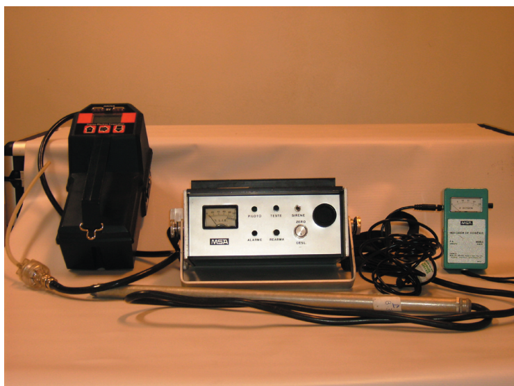
Figura 3.14: Equipamentos para detecção de gases e vapores inflamáveis e nível de oxigênio na atmosfera.
