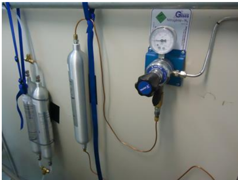
Foto 2. Linhas de gases que alimentam o LC-MS/MS.
