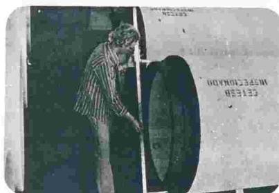
Tomadas de medidas físicas de um tubo de concreto protendido, na fase final de fabricação.
