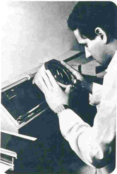
Exame de chapas gamagráficas de solda de tubo de aço.
