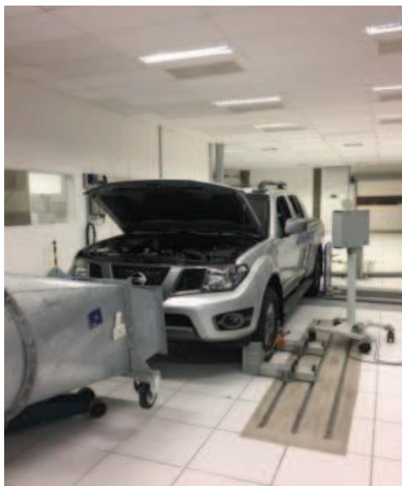
Fotografia 5 - Laboratórios de emissões: dinamômetro chassi diesel
