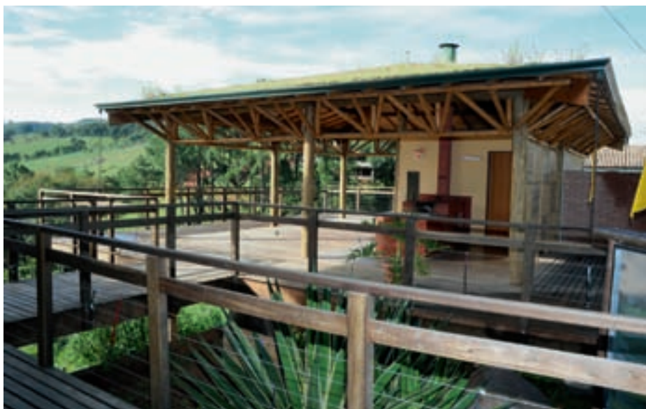
FIGURA 25 – CASA DO ARTESÃO EM PIRACAIA. TELHADO VERDE QUE FUNCIONA COMO UM FILTRO CONTRA POLUIÇÃO E NA MANUTENÇÃO DA UMIDADE RELATIVA DO AR. FONTE: ACERVO SMA.
