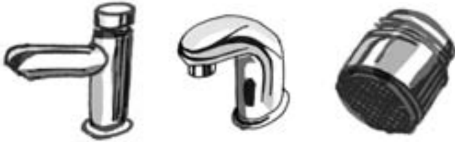
FIGURA 13 – TORNEIRA COM ACIONAMENTO HIDROMECAÂNICO, POR SENSOR DE PRESENÇA E ARE-JADOR PARA TORNEIRAS, RESPECTIVAMENTE. (ILUSTRAÇÃO: DIEGO VERNILLE DA SILVA)
