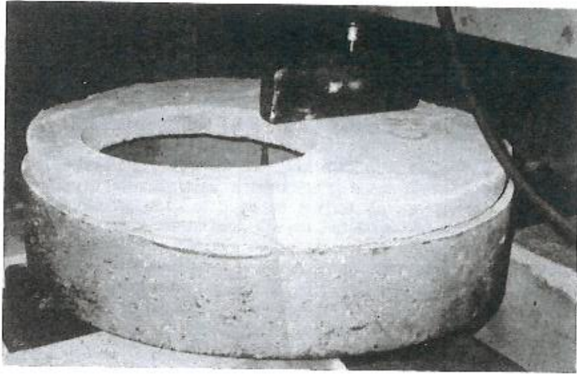
Fig. 5.12 — Ensaio de compressão nas capoeiras.
