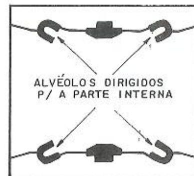
Fig. 4.41 — Junta para tubo de cimento-amiante.
