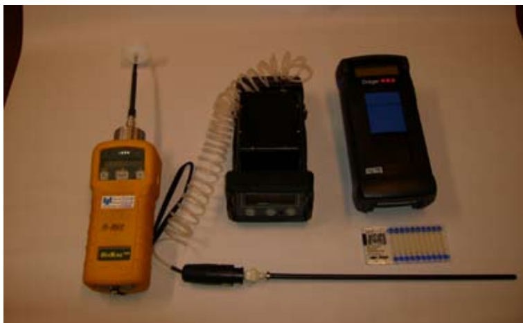
Figura 3.11 – Equipamentos para detecção de gases e vapores tóxicos.
