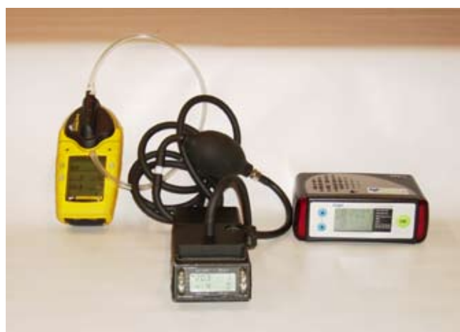
Figura 3.12 – Equipamentos para detecção de gases e vapores tóxicos e inflamáveis.
