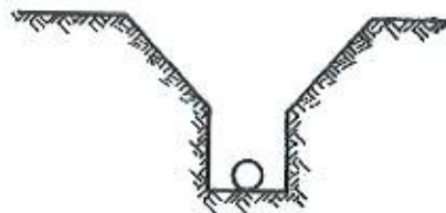
COM TALUDE INCLINADO
