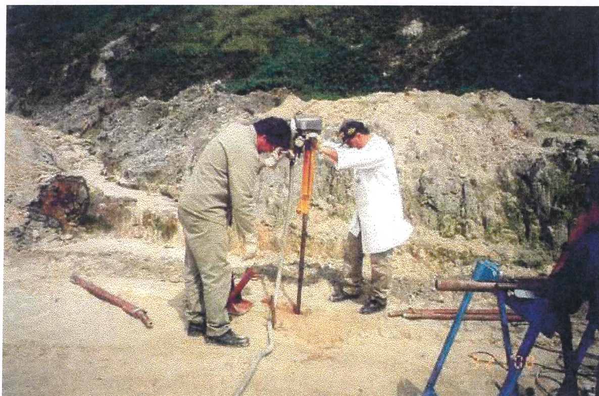
1.B. – Amostragem do fosfogesso com perfurações de trado mecânico
