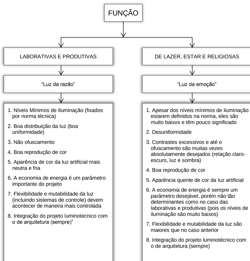
Figura 14. Parâmetros para projeto de iluminação. Fonte: adaptado de Arqto. Nelson Solano in (GONÇALVES et al, 2011)
