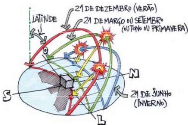
Figura 6. Desenho esquemático do movimento aparente do sol no hemisfério sul ao longo do dia no equinócio ( 21 de março ou 21 de setembro) e nos solstícios de verão (21 de dezembro) e inverno (21 de julho). Fonte: Luciano Dutra in LAMBERTS et al, 2014.
