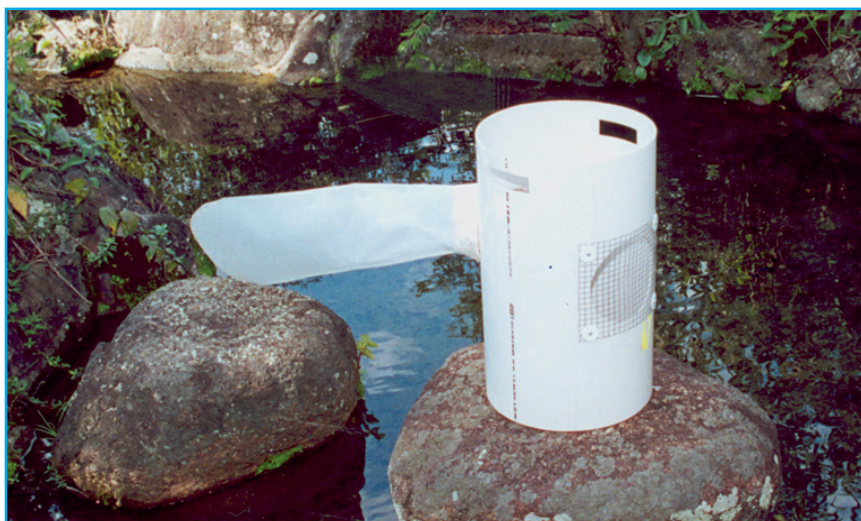
Figura 31. Delimitador Hess-Canton (Foto: Helena M. Watanabe/CETESB).
