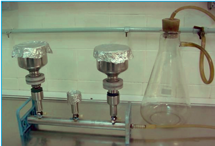
Figura 68. Sistema Porta Filtro para Filtração de Amostras para Ensaio de Clorofila \alpha e Feofitina \alpha em Laboratório (Foto: Carlos Jesus Brandão/CETESB).
