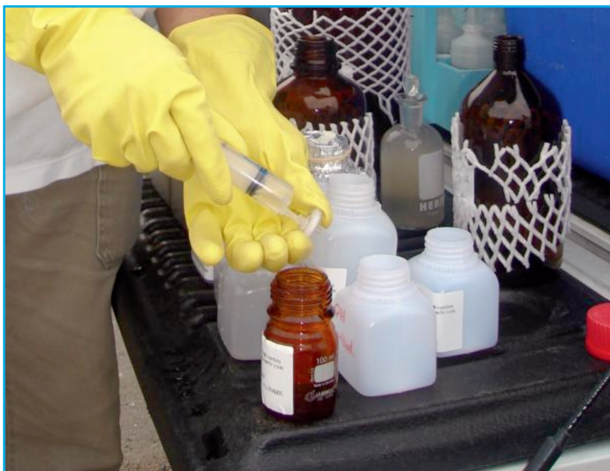
Figura 63. Filtração em campo de amostra para metais dissolvidos (Foto: Carlos Jesus Brandão/CETESB).
