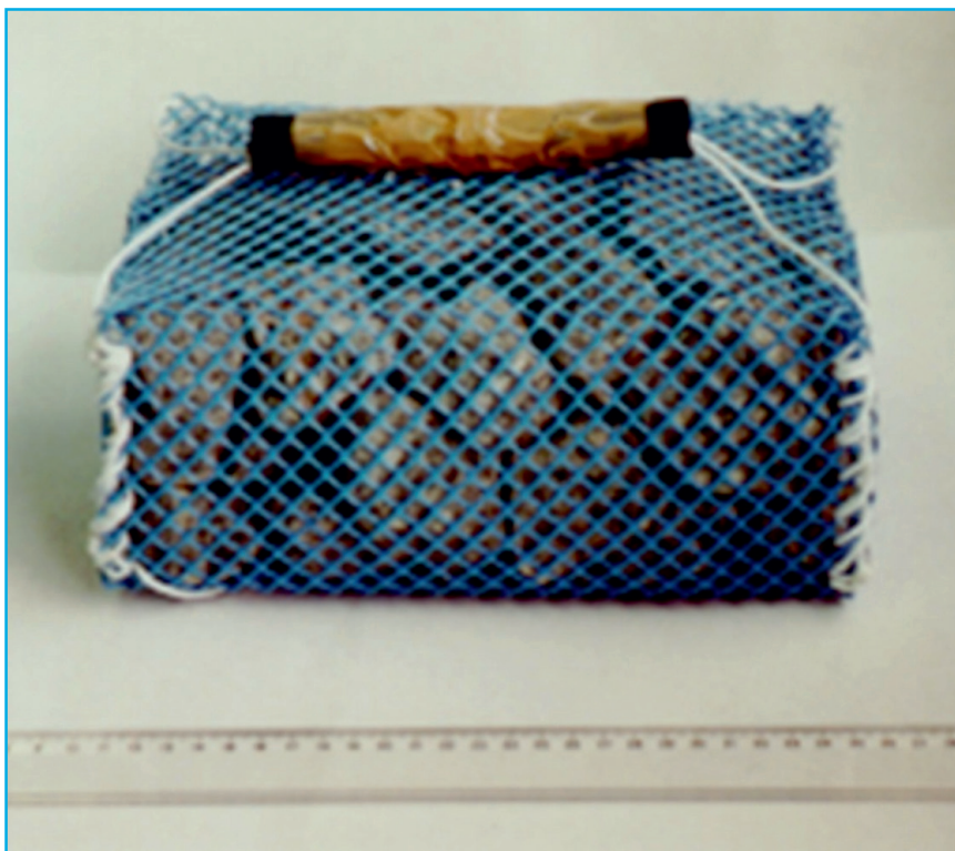
Figura 38. Substrato artificial do tipo cesto preenchido com pedra de brita (Foto: Monica L. Kuhlmann/CETESB).
