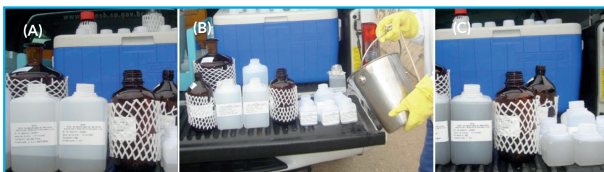
Figura 59. Coleta de amostras de água superficial: (A) Disposição dos frascos com identificação; (B) Distribuição da amostra em todos os frascos; (C) Frascos preenchidos com amostra (Fotos: Carlos Jesus Brandão/CETESB).
