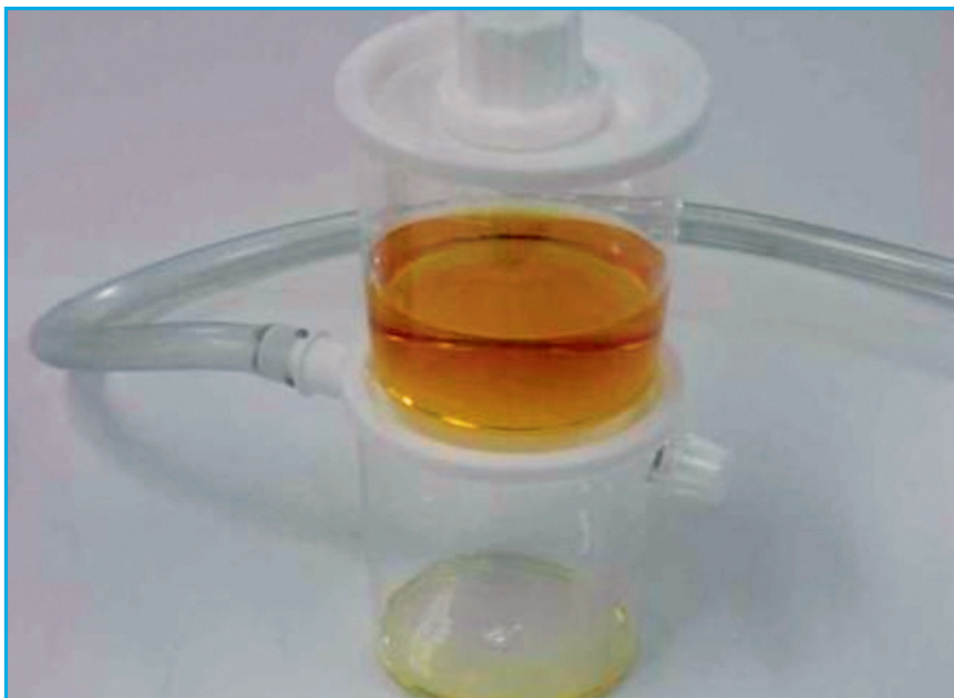
Figura 69. Sistema Porta Filtro para Filtração de Amostras para Ensaio de Clorofila \alpha e Feofitina \alpha em Campo (Foto: Carlos Jesus Brandão/CETESB).
