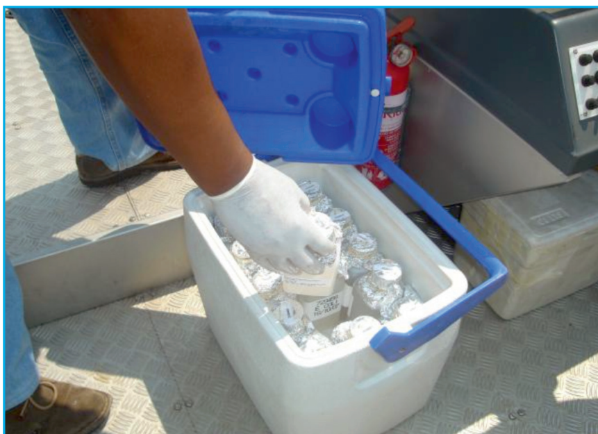
Figura 66. Acondicionamento e transporte de amostras para análises microbiológicas em caixa térmica sob refrigeração (Foto: Carlos Jesus Brandão/CETESB).
