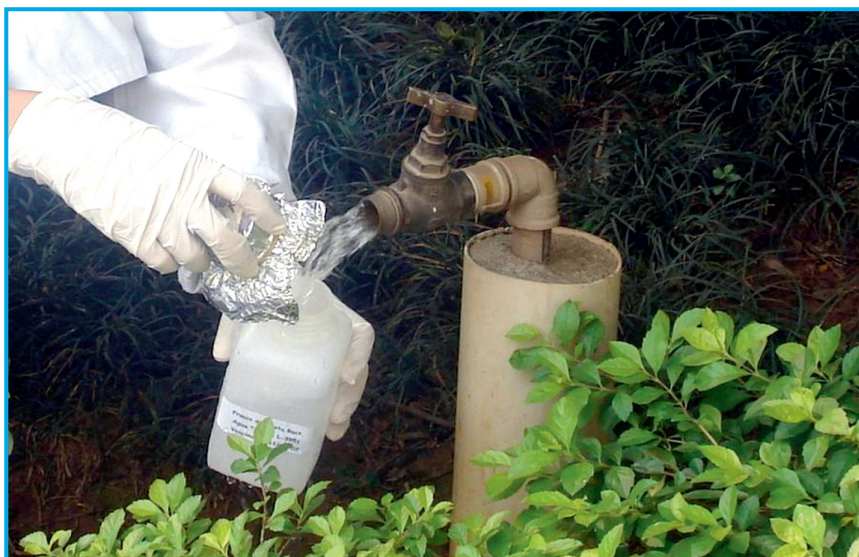
Figura 87. Coleta de amostra na torneira do jardim, após hidrômetro (Foto: Venício Pedro Ribeiro/CETESB).
