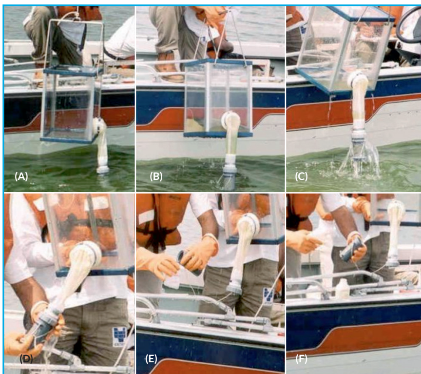
Figura 83: Coleta de amostras de zooplâncton com armadilha de Schindler-Patalas (A) Equipamento posicionado para descida; (B) Equipamento içado após coleta, (C) Amostra sendo filtrada, (D) Desconexão do copo coletor, (E) Transferência da amostra retida no copo coletor para o frasco, (F) Lavagem externa do copo coletor para a retirada de material aderido nas paredes (Fotos: José Jorge Neto/CETESB).
