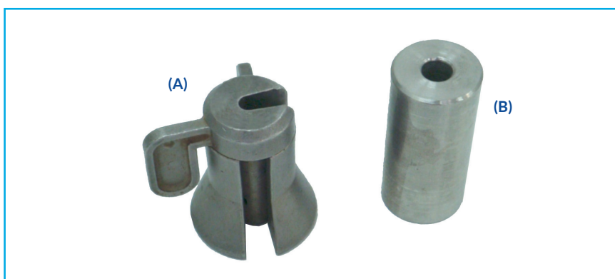
Figura 14. Mensageiro: (A) Equipamento industrializado; (B) Mensageiro manufaturado (Fotos:Carlos Jesus Brandão/CETESB).
