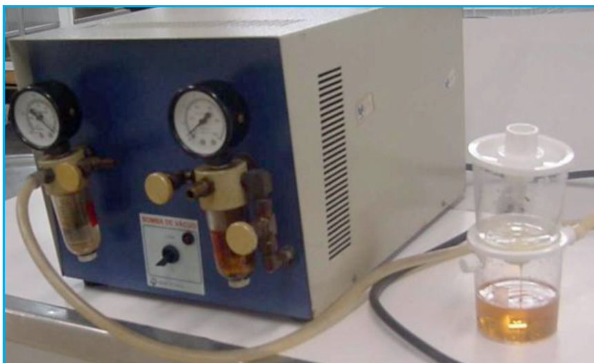
Figura 71. Bomba de Vácuo Elétrica para campo (Foto: Carlos Jesus Brandão/CETESB).
