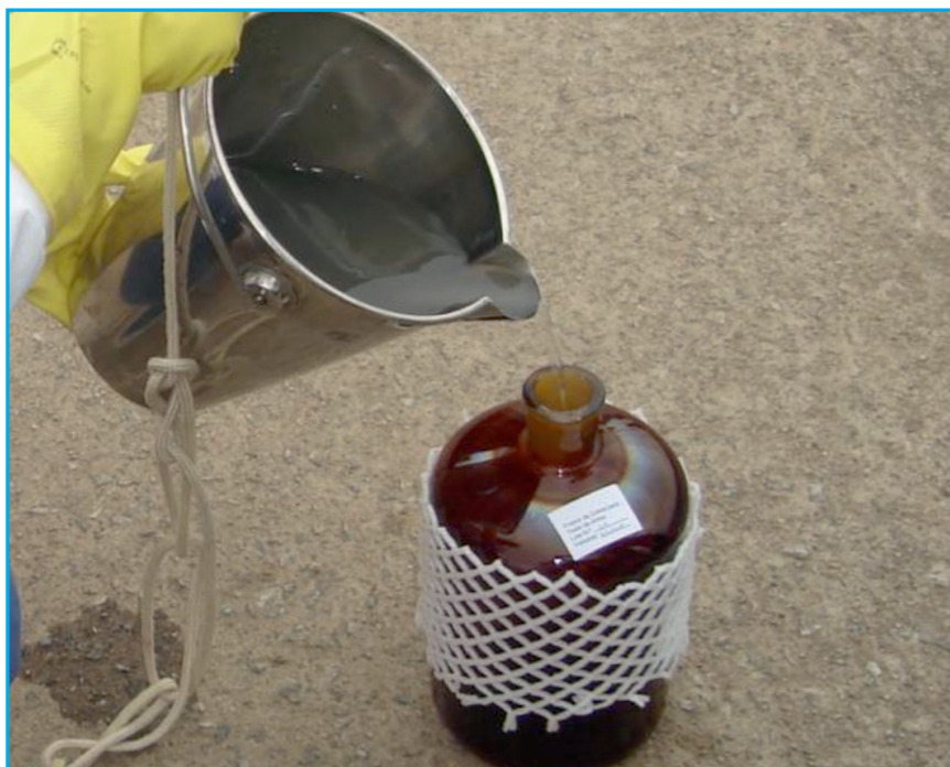
Figura 64. Coleta de amostra com balde de aço inox para Teste de Ames (Foto: Carlos Jesus Brandão/CETESB).
