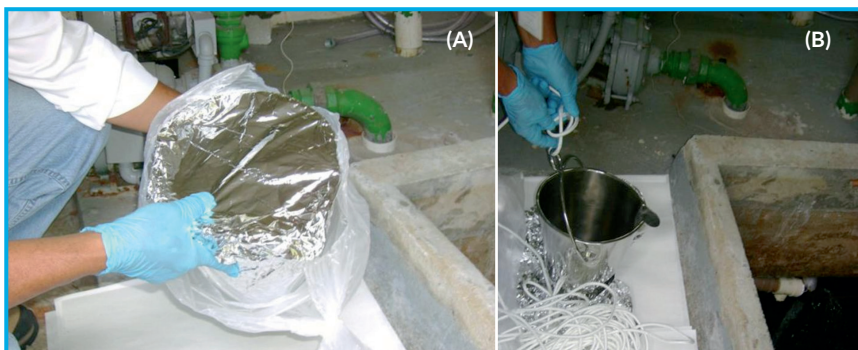
Figura 88. Coleta de amostras em reservatório com balde e corda estéreis: (A) Balde estéril, (B) Balde e corda estéril em procedimento de coleta (Foto: Venício Pedro Ribeiro/CETESB).
