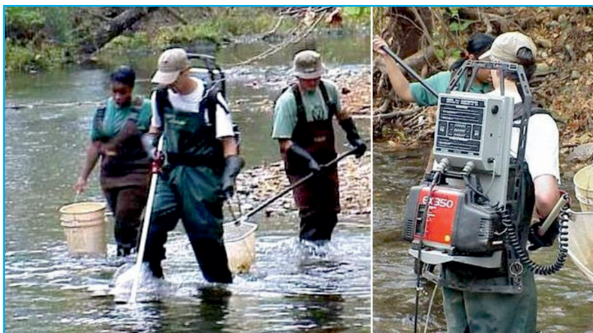
Figura 57. Pesca elétrica com aparelhagem do tipo móvel (mochila). Foto: American Fisheries Society (usado com permissão)
