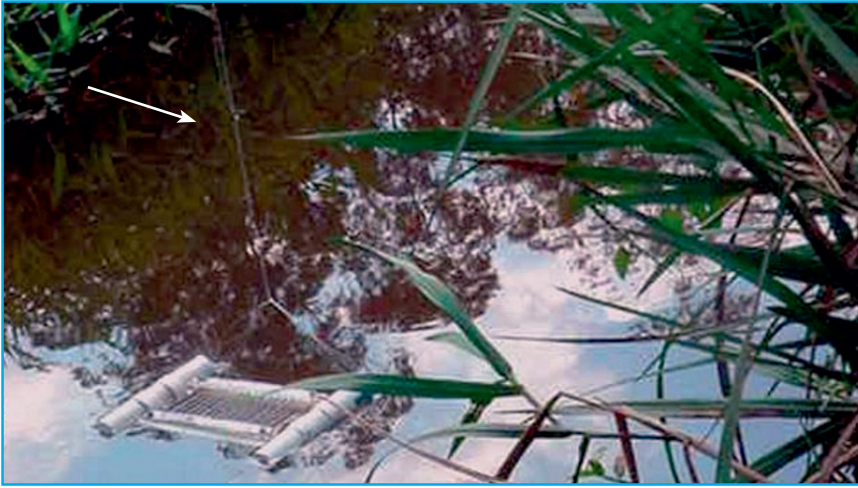
Figura 40. Substrato artificial do tipo flutuador, com lâminas de vidro: Detalhe do fio náilon de sustentação do flutuador (Foto: Rita Cerqueira Ribeiro de Souza/CETESB).
