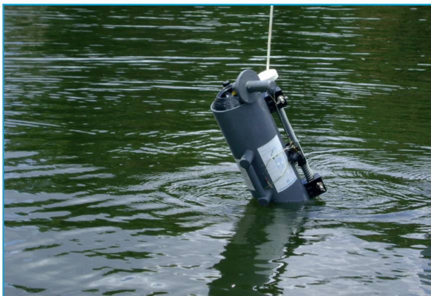
Figura 62. Coleta de amostra em profundidade com garrafa de van Dorn de Fluxo Vertical (Foto: Carlos Jesus Brandão/CETESB).
