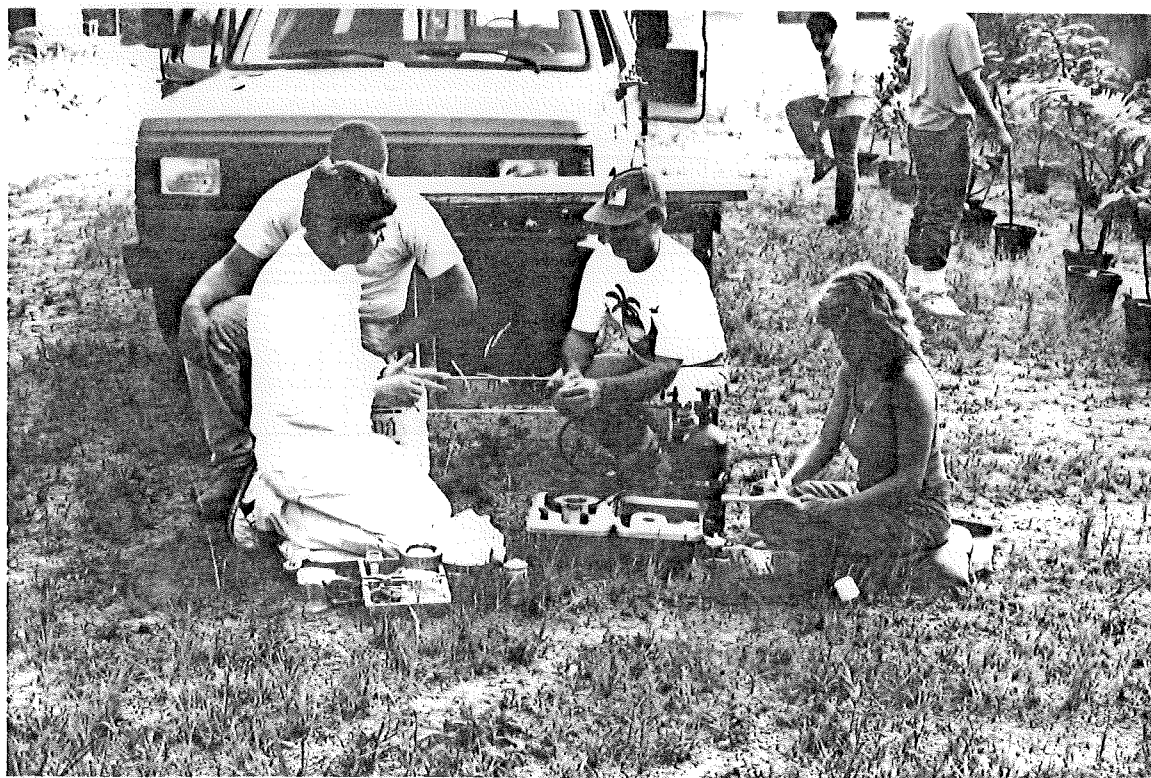
Câmara de Scholander para medição do potencial hídrico foliar
