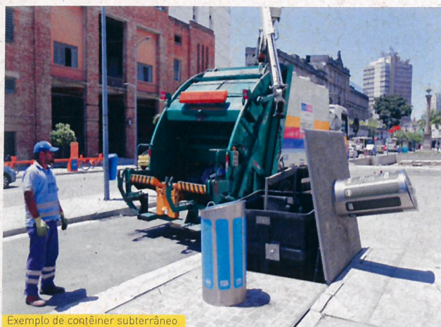
Exemplo de contêiner subterrâneo
