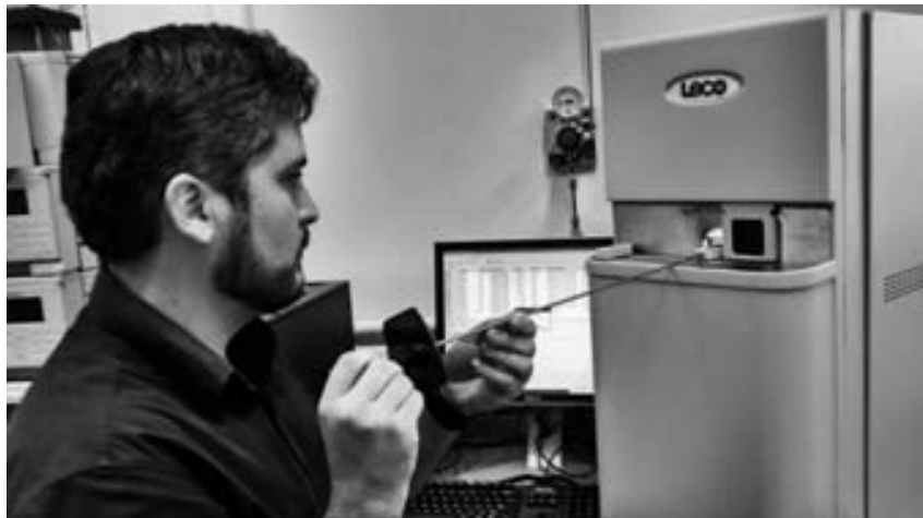
Figura 4 - Determinação do teor de carbono realizado em equipamento LECO C632 do Laboratório de Métodos Quantitativos (LMQ), ESALQ/USP
