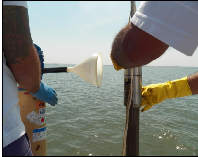
Figura 1.7 – Procedimento de extrusão do perfil sedimentar, sob fluxo de nitrogênio pressurizado.
