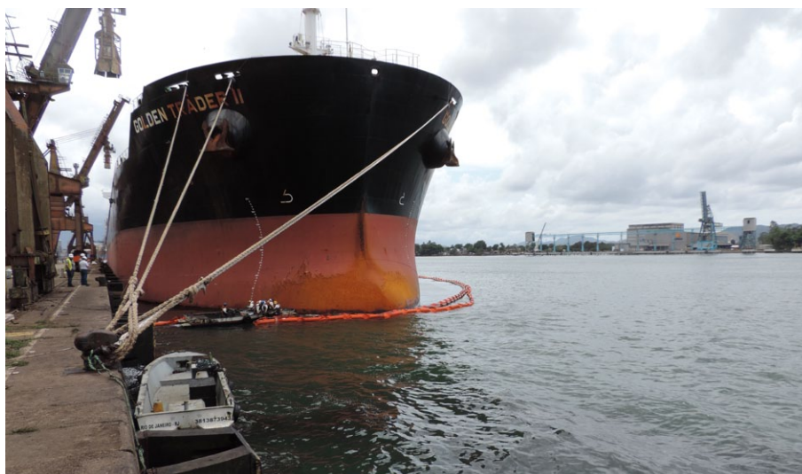
Figura 5.8 – Navio cercado por barreiras de contenção
