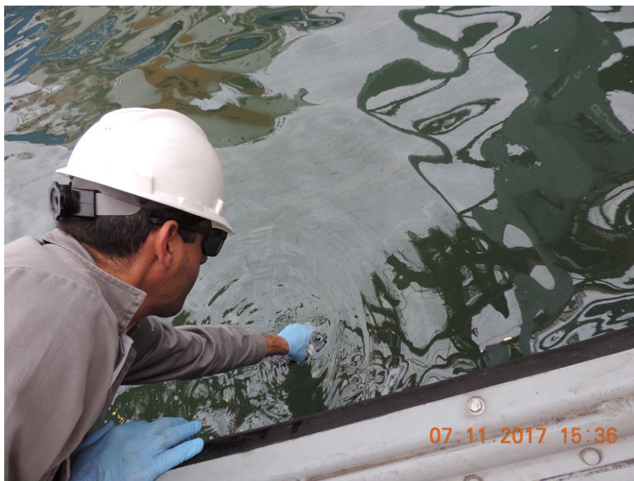
Figura 5.10 – Coleta de amostra de óleo pelo técnico do Setor de Atendimento a Emergência
