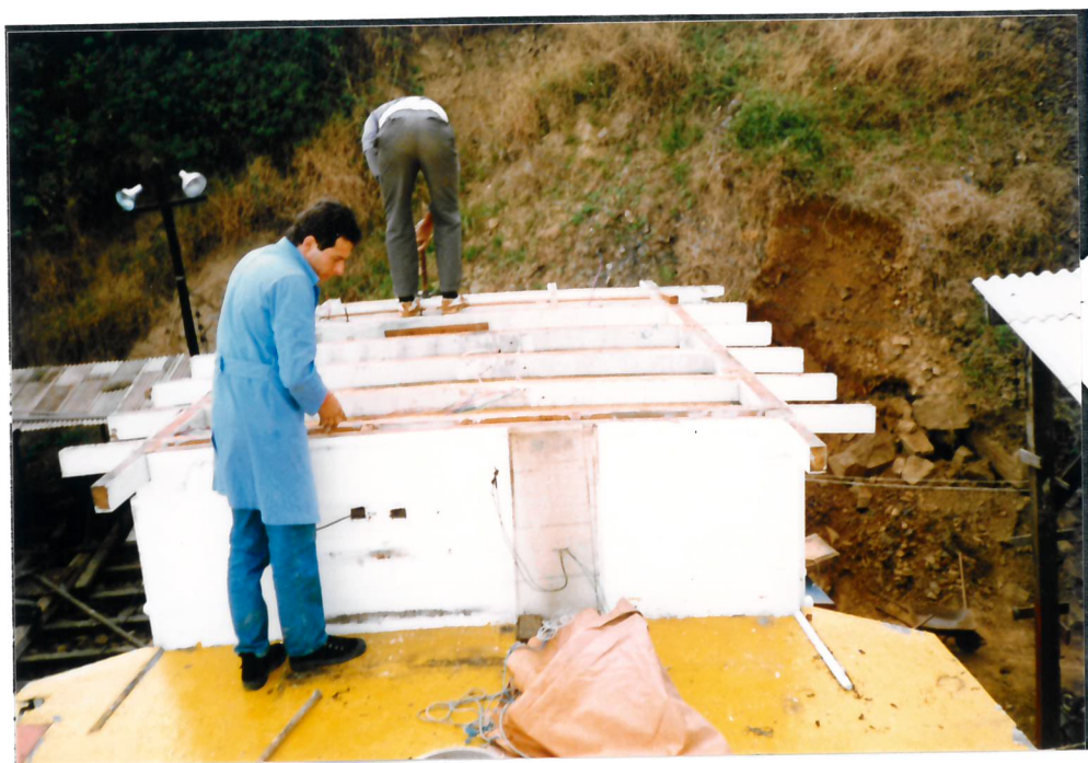
Troca de toda tolda da embarcação com recapeamento com fibra de vidro
